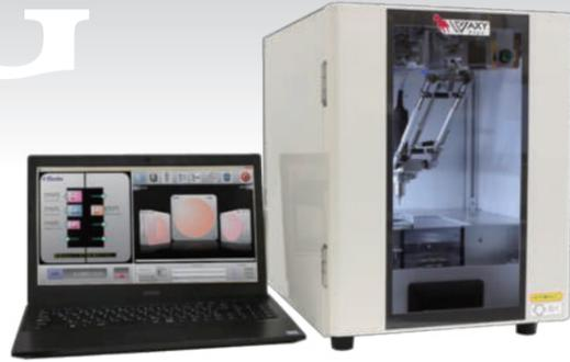
WAXY Plus(ワクシー プラス)は保険技工をコンセプトに生産性と効率化を考慮して設計したミリングマシンです。独自の平行リンク機構と高耐久・高速スピンドルモーターを採用し、ワックスの高速加工を実現しています。ワックスだけでなく、CAD/CAM冠のブロック材料はもちろん、PMMA、ジルコニア等のディスク材料の加工にも対応しています。「正確さ」「速さ」「大きさ」から「価格」まで、日本の歯科技工のために考えたミリングマシンです。
