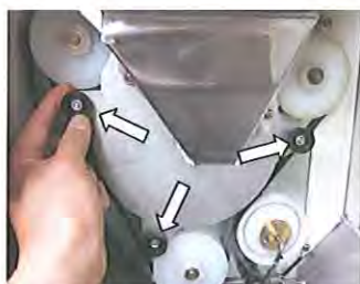
① 3か所のローレットネジを外します。
