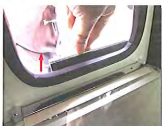
作業ボックス内側に清掃口を開閉 する取っ手が付いていますので清 掃時、取っ手を持ち上げて下さい。
