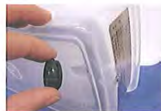
網付ポリ容器底のゴム栓を抜いて研磨屑を 排出して下さい。
