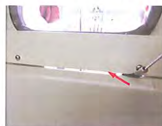
ガラス扉下に溜まった砂を開口 した清掃口から作業ボックス内 に押し込んで戻してください。
